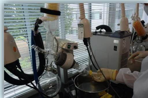
↑エバポレーターとは物質の入った容器内の気圧を下げて物質の沸点を下げる装置のこと
